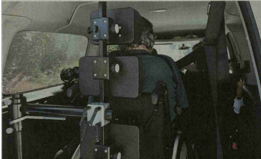
Der Rollstuhl wird im Fahrzeug mehrfach gesichert. Eine Stütze schützt den Kopfbereich.
